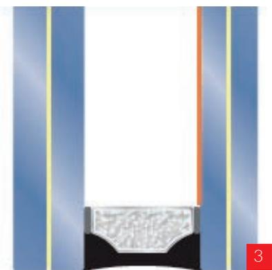
**Höchste Schalldämmung durch spezielle Schallschutzfolien optional mit Sicherheits-Eigenschaften:**
