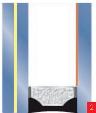
**Erhöhte Schalldämmung durch spezielle Schallschutzfolie optional mit Sicherheits-Eigenschaften:**
